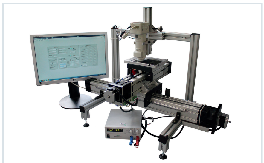
Bild 3. Der automatische Oberflächenprüfstand zur Farb- und Glanzmessung wurde am IKT entwickelt (© IKT)
